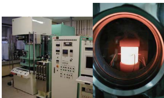
図1 パルス通電焼結装置と焼結の様子 (SPSシンテックス製 SPS-3.20MK-IV)
